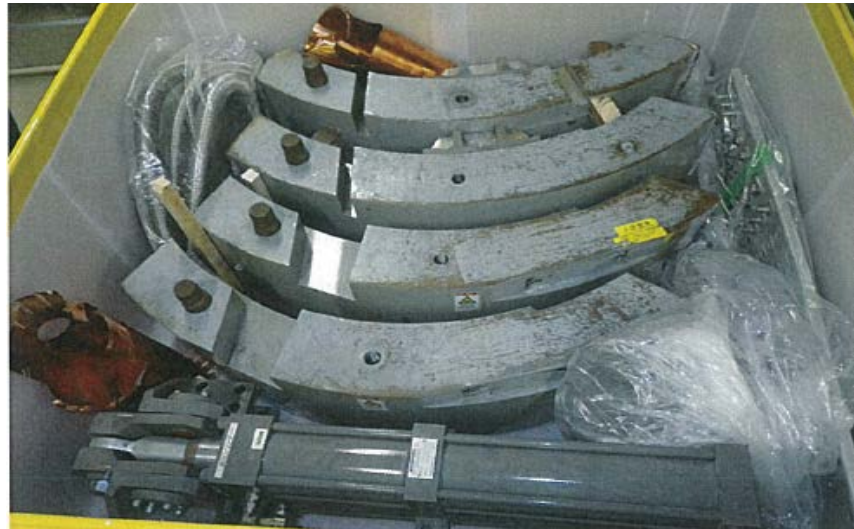
サイクロトン解体部品 (約2トン)
